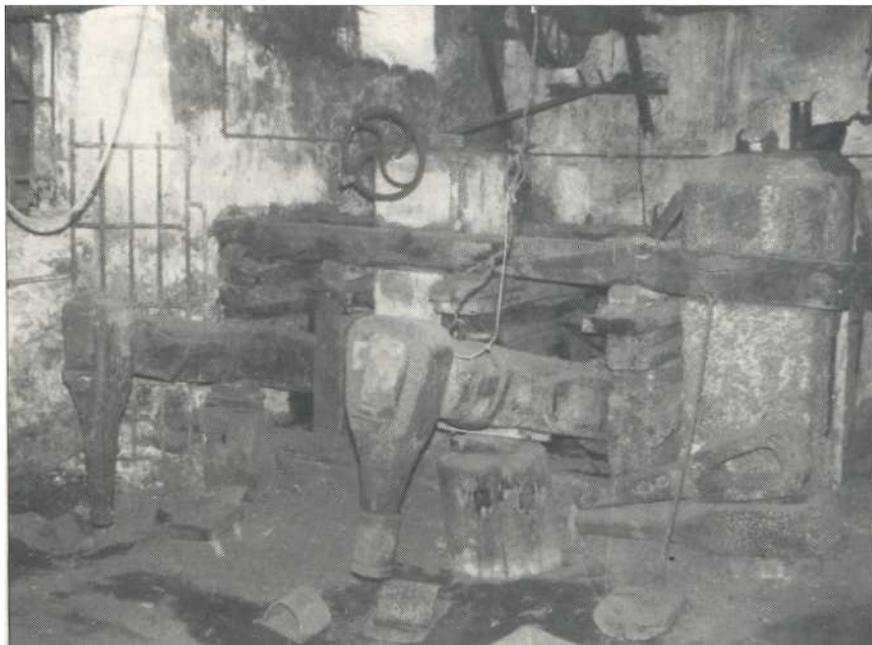
Il maglio mosso dalla ruota idraulica usato per la lavorazione del rame.
